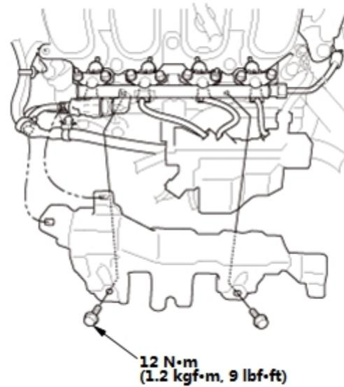
5. 高压燃油泵盖 - 安装
