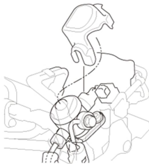
2. 燃油分配管盖 - 拆卸
