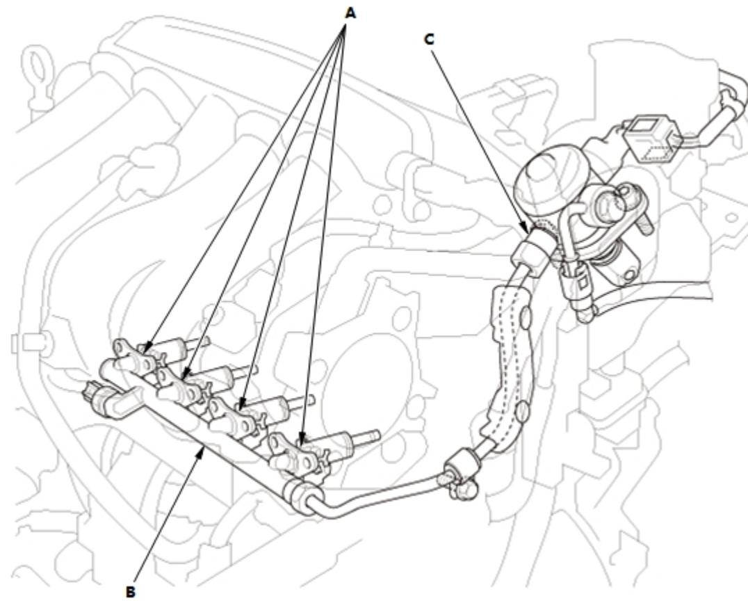
2. 将车辆转为 ON 模式，但不要起动发动机。燃油泵运转约 2 秒后，就会给低压燃油管路加压。重复此过程两到三次，然后检查
